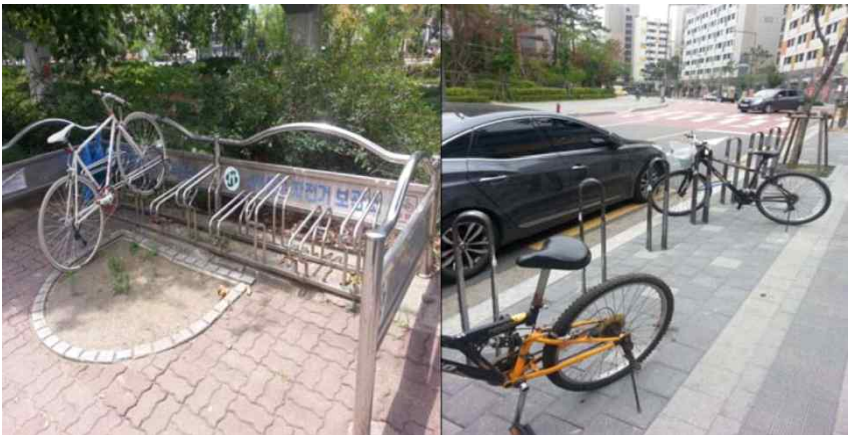
들어 올리는 자전거 거치대(좌)와 밀어 넣는 자전거 거치대(우) © 김경희(2015), 『성별영향분석평가의 정책 개선 활성화를 위한 스토리텔링 연구』, 94쪽 김은희 제공
